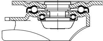
轮架: LH/BH 系列 - 采用重型钢压制成型, 万向轮架带重型支架轮叉和顶板配件, 使用非常稳定的中心柱拧接并固定, 万向旋转机构采用双滚珠轴承, 另外通过四个特殊成型、硬化的轴承套盖进行加强, 因此对震动及冲击特别不敏感。
