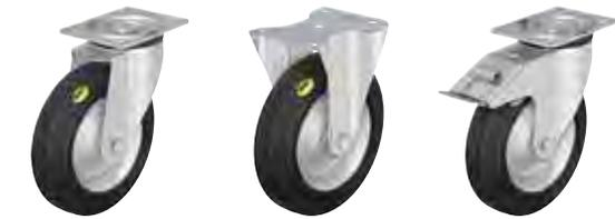
轮架: L/B/BH 系列 - 采用钢压制成型, 万向轮架, 万向旋转机构采用双滚珠轴承, 带稳定的中心栓(轮径 160-280 mm), 带万向旋转机构密封件(例外: 顶板尺寸 175x175 mm)。万向旋转机构采用比克利专用动载荷铆接工艺, 确保运行轻盈, 最大限度地减小万向旋转寸动, 并且通过对球轨道进行冷作硬化而达到长使用寿命。
